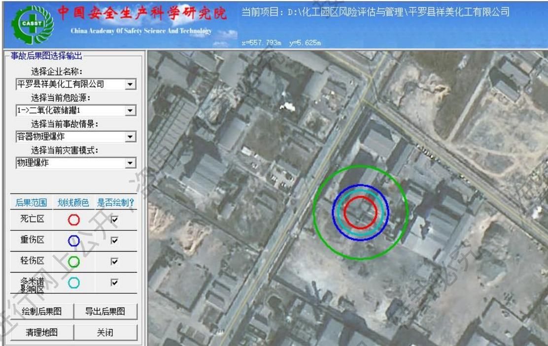
图 5.3-2 二氧化碳储罐伤害范围及多米诺效应模拟图
